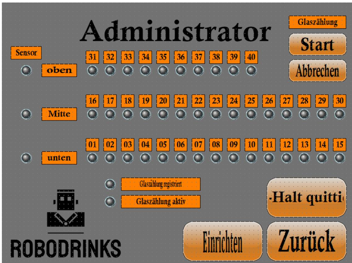
Abb. 8 - HMI-Bild für die Glaspositionen
