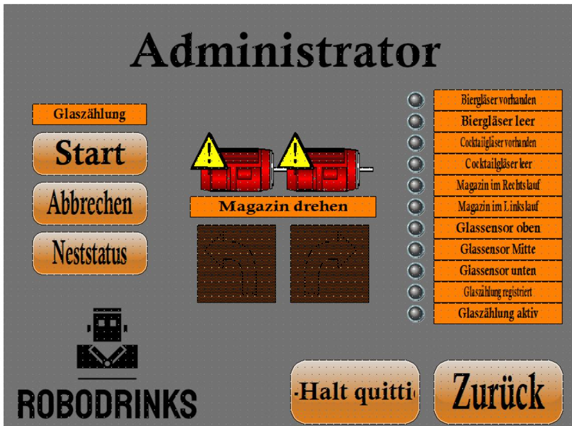
Abb. 7 - HMI-Grundbild für das Magazin
