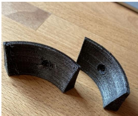
Abb. 53 Druckversuch TPU Backen
