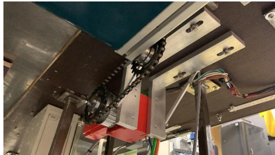
Abb. 89 Antrieb mit Motor Halter Getränkeausgabe
