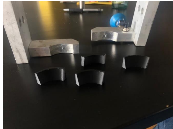
Abb. 52 Erste Version Greiferbacken
