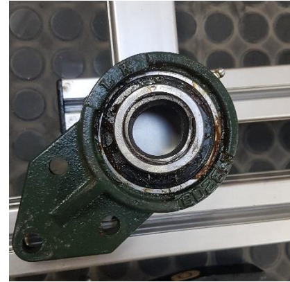
Abb. 85 Lagerung des Defekten Transportbandes
