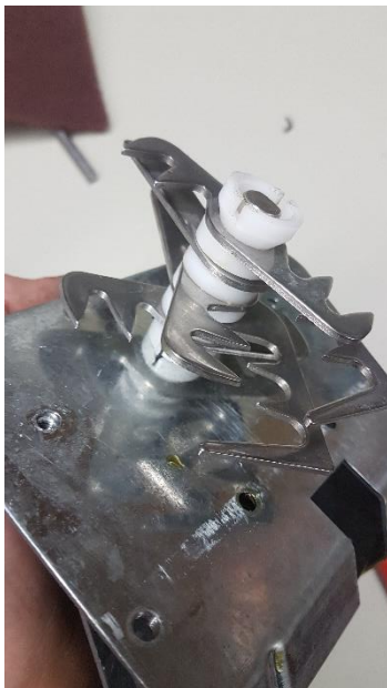
Abb. 77 Defekte Crush Einheit
